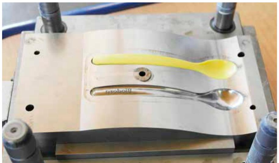
Im Spritzgussverfahren wird heißer Kunststoff ins Werkzeug gespritzt – nach dem Erkalten kann der neue Gegenstand entnommen werden.
