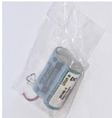
Beschädigte Akkus oder korrodierte Batterien sind oft unterschätzte Gefahrenquellen. Sogar eine Selbstentzündung ist bei (unsichtbarer) Beschädigung der inneren Membranen möglich.
