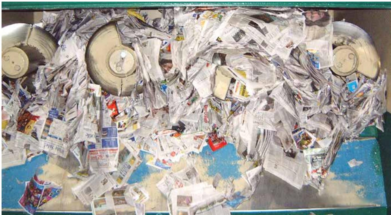
Ein „Ballenbrecher“ öffnet die Altpapierballen, damit das Material dem Verwertungsprozess zugeführt werden kann.
