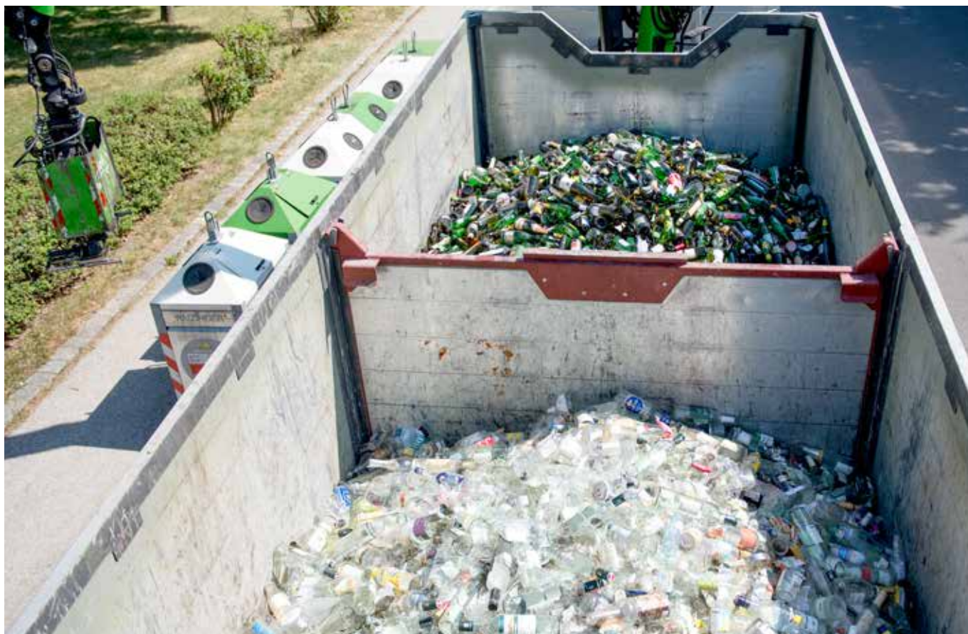
Durch ein Zweikammern-System im Sammelfahrzeug bleiben Weiß- und Buntglas zuverlässig getrennt.
